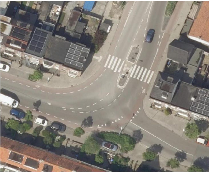
Figuur 3: Door wegbeheerder aangedragen voorrangskruispunt waar de voorrangsweg in een bocht ligt. Er zijn verschillende voorbeelden van voorrangskruispunten met voorrangsweg in een bocht aangeleverd.
