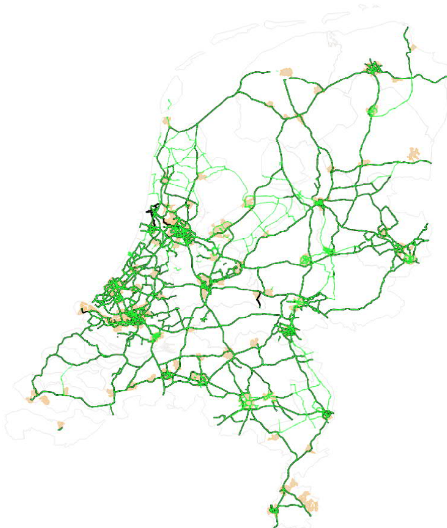
Figuur 2: Het wegennet met 'vaste' en 'mobiele' inwinning van reistijden, situatie najaar 2017. De zwart gekleurde wegen zijn er in 2017 bijgekomen.
