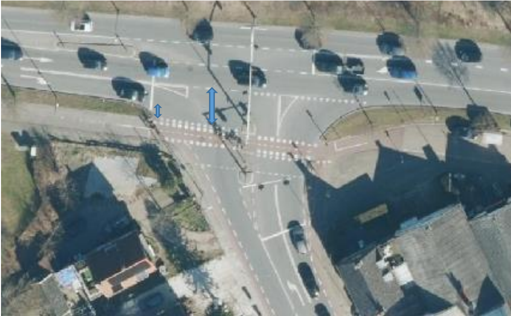
Figuur 43 Voorbeeld ETW-GOW kruispunt met VRI met twee zeer verschillende mogelijke maatvoeringen voor de mate van uitbuiging: rechter pijl op basis van de tussenberm voor verkeer dat de voorrangweg verlaat, linker pijl op basis van verkeer vanuit de zijweg
