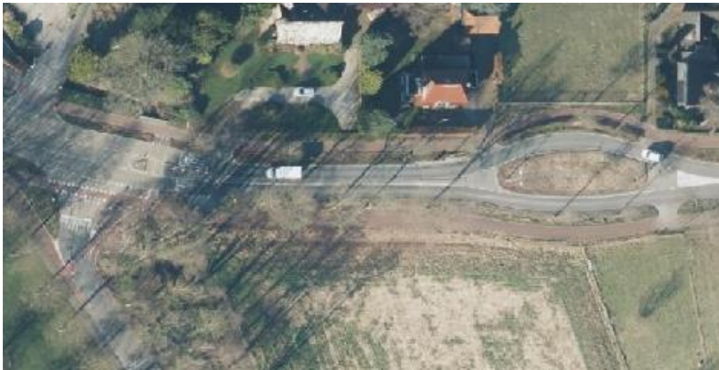
Figuur 36 Voorbeeld van snelheidsremming met een middengeleider met grote asverspringing
