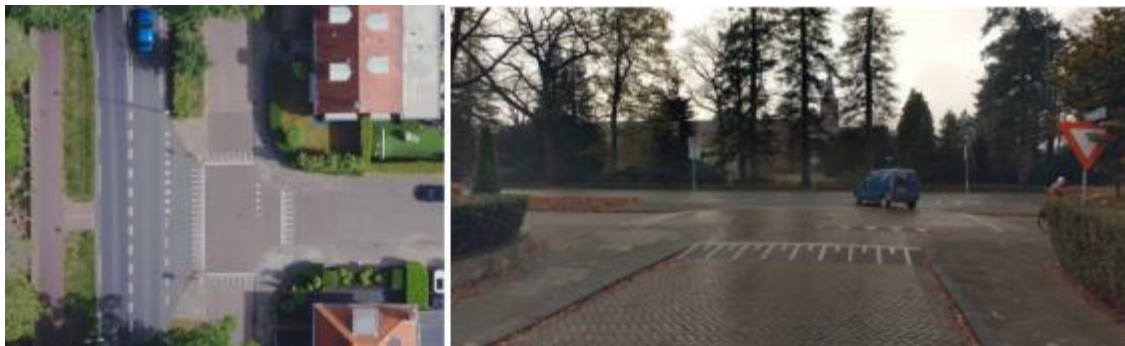
Figuur 7 Voorbeeld van twee nabije voorrangskruispunten: één op de voorrangsweg en één op de ventweg
